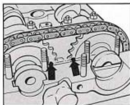
Markierung für Einbaulage der Nockenwellen
